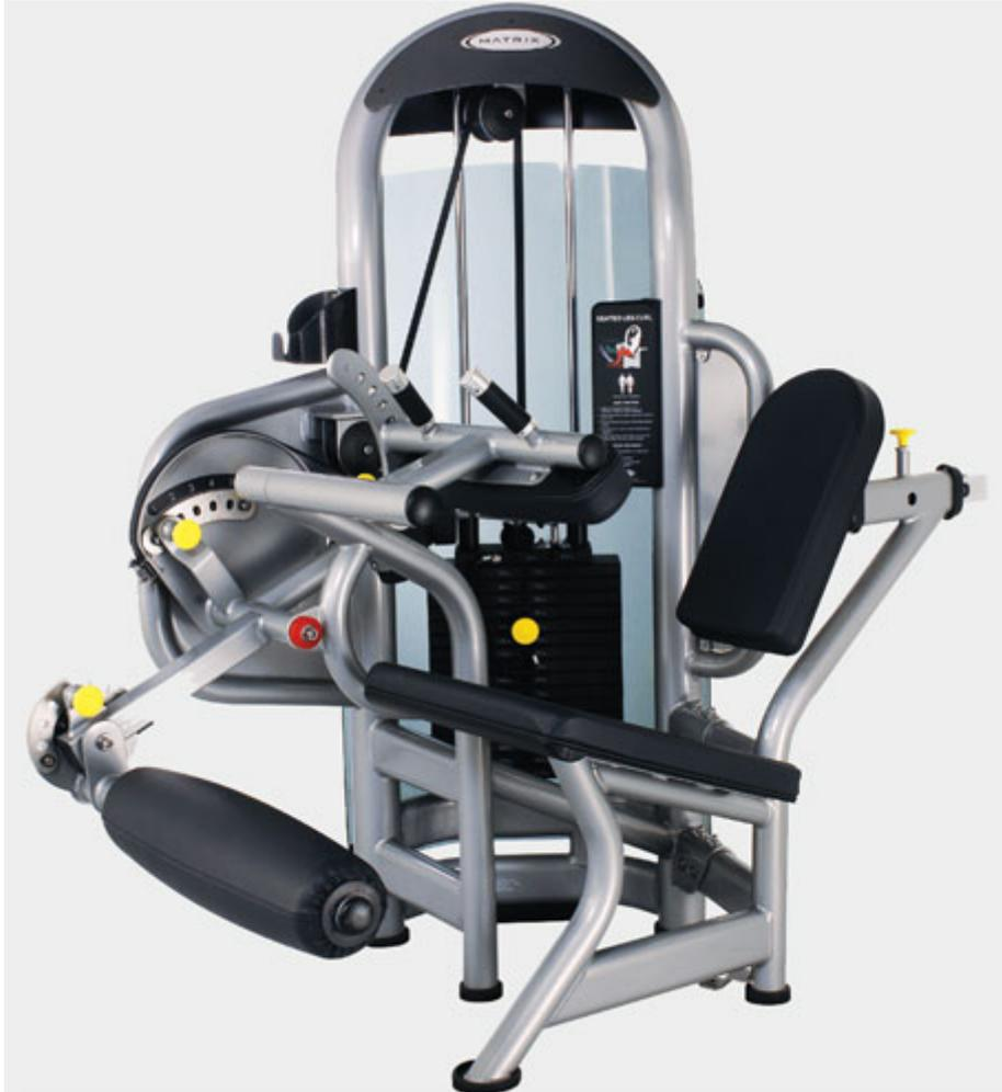
Тренажер для спортзалов на сгибание ног сидя. Угол между спинкой и валиком-опорой такой, что не создается излишнего давления на заднюю поверхность ног. Регулировка стартового положения. Большой валик-опора для ног. Биомеханически верная траектория движения. Защита весового стека акриловым щитом.
