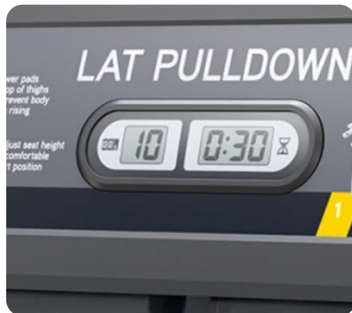
Встроенный счетчик повторений и времени подхода
