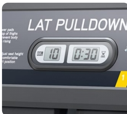
Встроенный счетчик повторений и времени подхода
