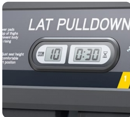
Встроенный счетчик повторений и времени подхода
