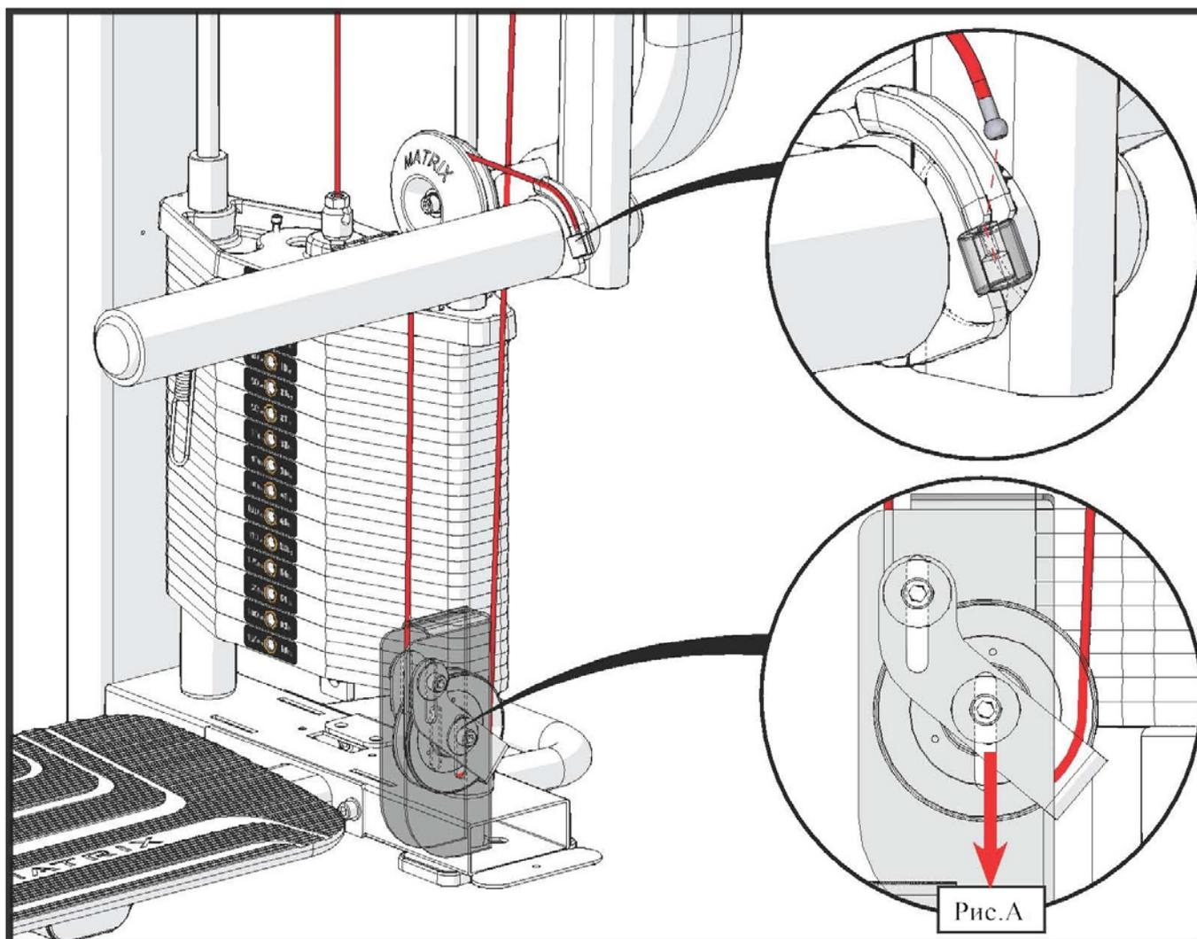
*Натяжение кабеля регулируется фиксатором. (См. Рис.А)*
