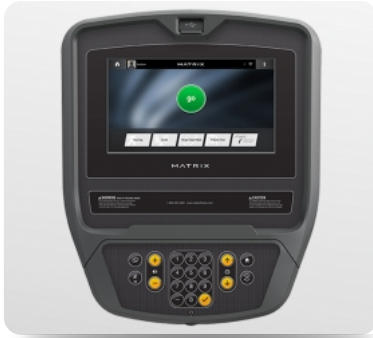
10-ти дюймовый сенсорный TFT-LCD дисплей Vista Clear™ на ОС Android с Wi-Fi доступом к различным интернет приложениям
